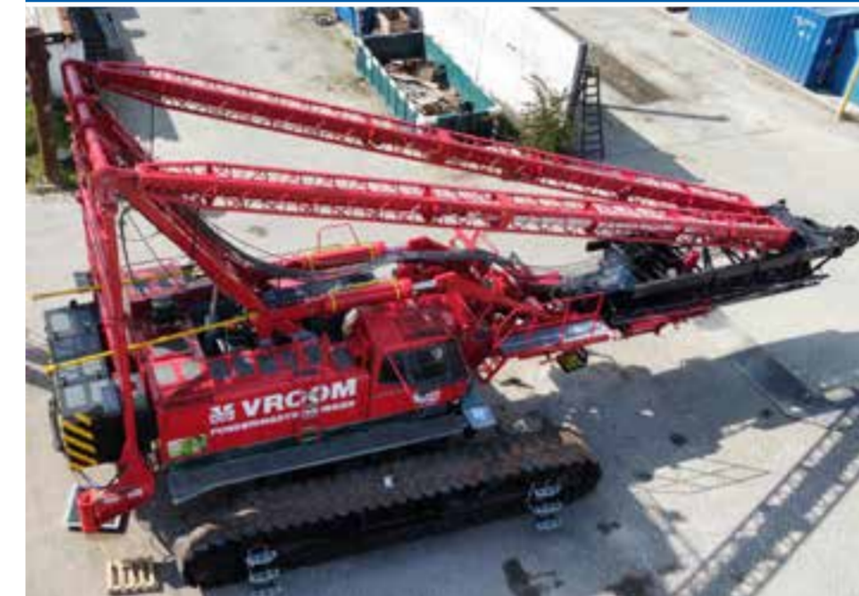
Volledige revisie van funderingsmachine bijna voltooid bij van den Heuvel Werkendam Inclusief upgrade met onder meer Stage V motor
